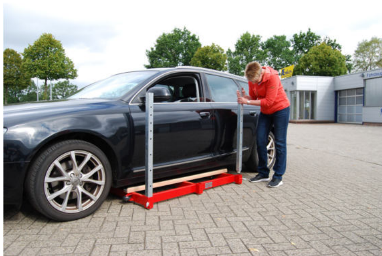
Die Hebebeine werden in die vier Rahmenführungen des Autohebetisches von oben eingesetzt.
